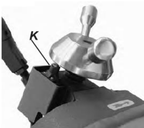
Рис. 20 Регулировка натяга ленточной пилы.
