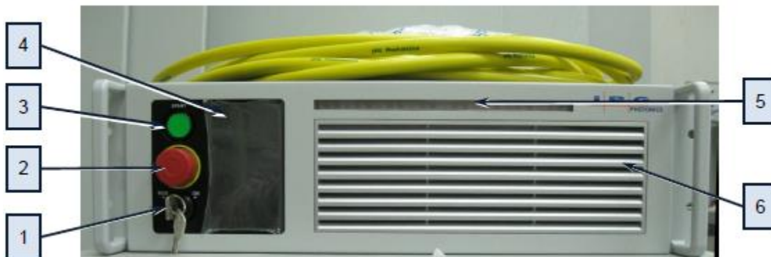
Рис. 36 Источник лазера. Передняя панель управления.
