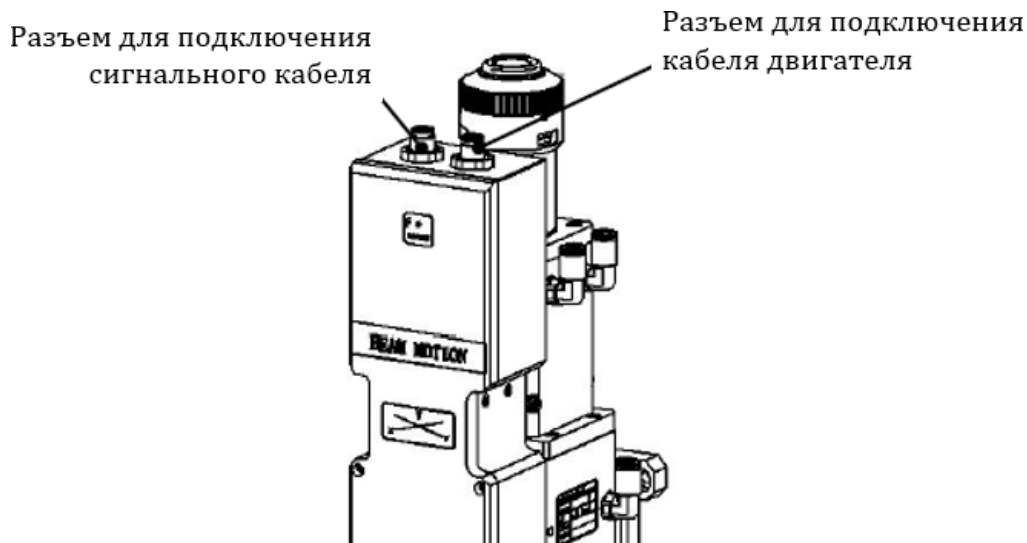
Рис. 24 Лазерная головка. Цифровое управление.
