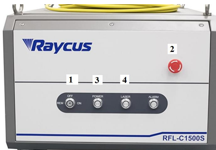
Рис. 37 Источник лазера. Передняя панель управления.
