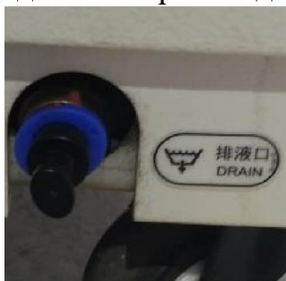
Рис. 56 Поверните сливной выключатель по часовой стрелке для слива воды
