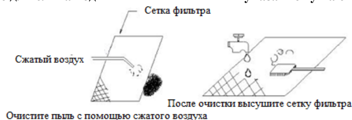
Рис. 58 Схема чистки воздушных фильтров
