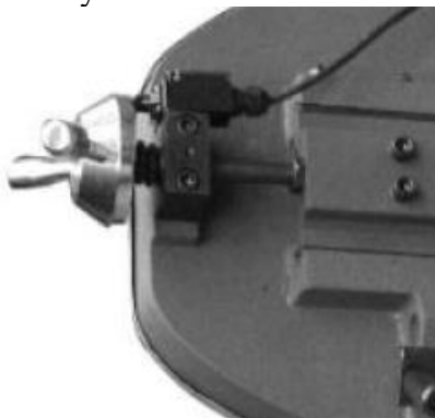
Рис. 17 Регулировка натяга ленточной пилы.
